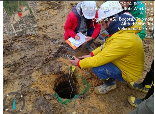
Fotografía 8. Medición de gases prebarrenado
